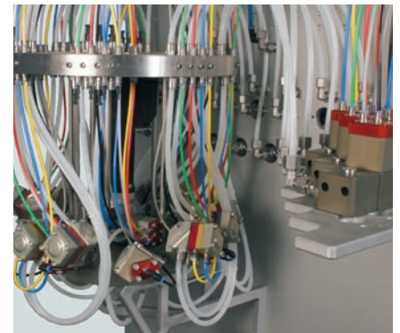
Promera-Vielfarbenmischkopf: Für den Automobilbau ein Kostenproblem weniger
